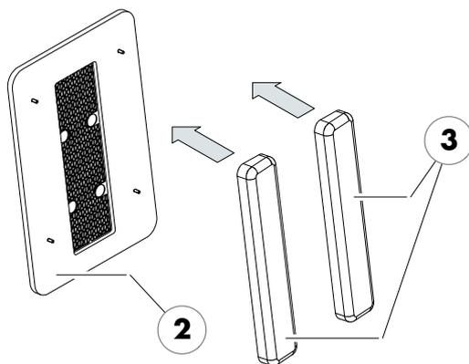
4. Die beiden Rückenpolster (3) mit je zwei Schrauben auf die Strahlereinheit (2) montieren.
